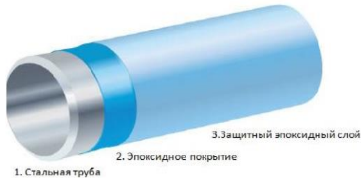
Рисунок 5. Исполнение изоляции на основе двухслойного эпоксидного покрытия
