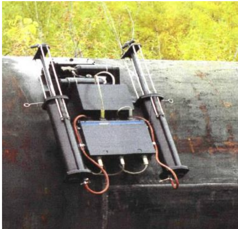
Рисунок 1. Автоматизированная ультразвуковая установка «АВТОКОН-МГТУ»
